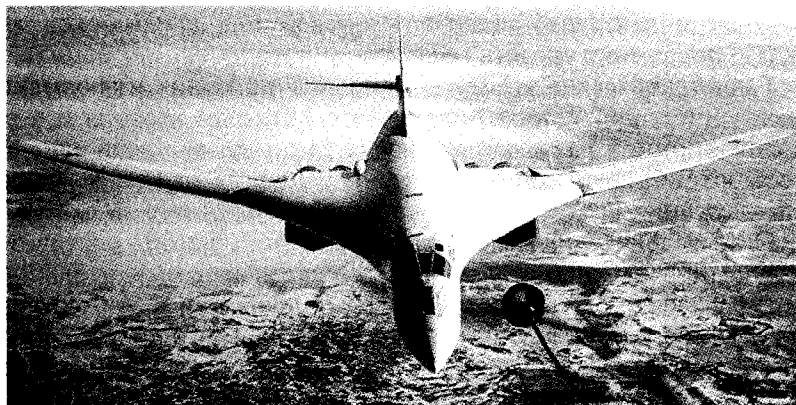
Рис. 88. Стратегический сверхзвуковой ракетоносец-бомбардировщик Ту-160: размах крыльев — 35,6/55,7 м; длина — 54,1 м; высота — 13,1 м; масса максимальная взлетная — 275 т; максимальная боевая нагрузка — 45 т; крейсерская скорость — 960 км/ч; дальность действия — 7300 км; потолок — 18000 м; вооружение — ракеты, бомбы (в том числе ядерные); экипаж — 4 человека
