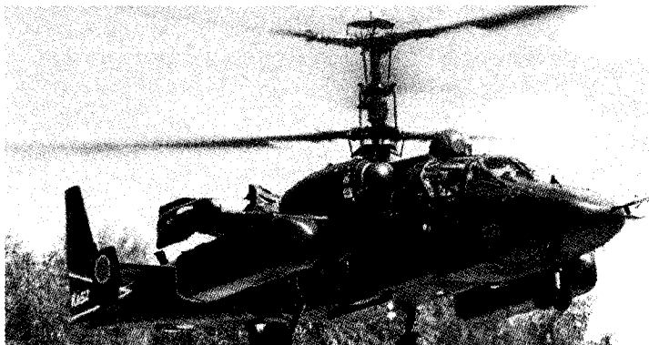
Рис. 92. Боевой ударный вертолет Ка-52 «Аллигатор»: диаметр несущего винта — 14,50 м; длина с вращающимися винтами — 15,90 м; масса максимальная — 10 400 кг; потолок — 5500 м; дальность действия — 520 км; вооружение — 30-мм пушка с боезапасом в 500 патронов; боевая нагрузка — 2000 кг на 4 узлах подвески (ПТУР, унифицированные контейнеры с пулеметным и пушечным вооружением, НУР, УР); экипаж — 2 человека
