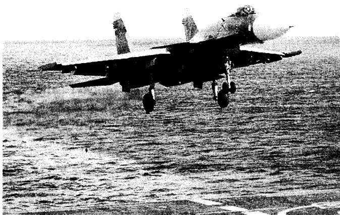
Рис. 99. Истребитель корабельного базирования Су-33: размах крыла — 14,7 м; длина 21,19 м; высота — 5,63 м; масса максимальная взлетная — 32 000 кг; максимальная скорость на большой высоте — 2300 км/ч; потолок — 17 000 м; дальность — 3000 км; вооружение — 30-мм пушка (250 патронов), УР; экипаж — 1 человек
