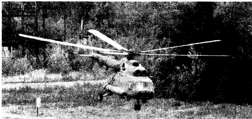
Рис. 86. Транспортный боевой вертолет Ми-8: длина — 18,22 м; высота — 5,65 м; диаметр главного винта — 21,29 м; максимальная взлетная масса — 12200 кг; крейсерская скорость — 225 км/ч; дальность действия — 465 км; потолок — 4500 м; экипаж — 2—3 человека; полезная нагрузка — 4000 кг в кабине или 3000 кг на подвеске; вооружение — 7,62-мм или 12,7-мм пулемет; боевая нагрузка — 1000 кг (ПУ, бомбы или ПТУР)
