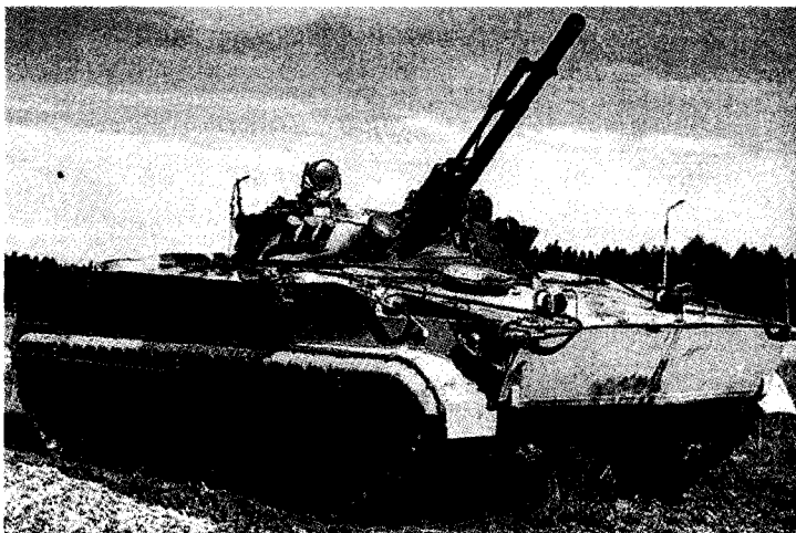
Рис. 82. Боевая машина пехоты БМП-3: боевая масса — 18,7 т; длина — 6,7 м; ширина — 3,3 м; высота — 2,65 м; мощность двигателя — 500 л. с.; максимальная скорость по шоссе (на плаву) — 70 (10) км/ч; запас хода по шоссе — 600 км; темп стрельбы — 300 выстрелов/мин; дальность стрельбы — 4000 м; вооружение — 100-мм пушка; боекомплект — 40 выстрелов ПТУР; боевой расчет — 10 человек (3 человека — экипаж, 7 человек — десант)
