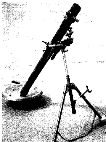
Рис. 84. Миномет 2Б14-1 «Поднос»: калибр — 82 мм; дальность стрельбы — 4270 м; темп стрельбы — 24 выстрелов/мин; расчет — 4 человека; масса — 39 кг; боекомплект — 120 выстрелов
