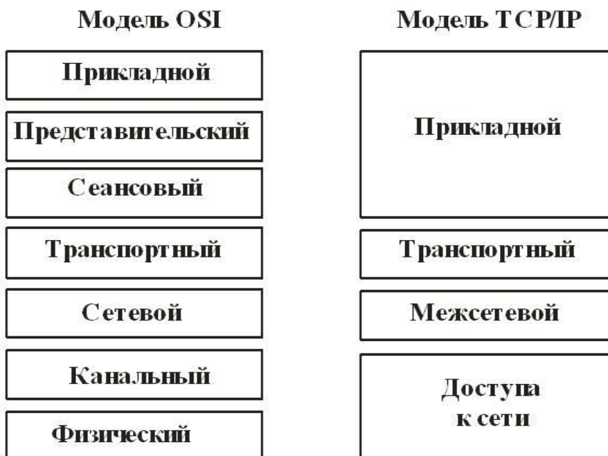
Рисунок Модели OSI и TCP/IP
